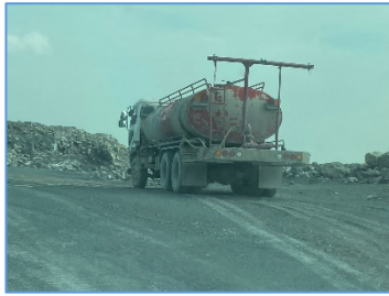
1. ฉีดพรมน้ำบริเวณที่ก่อให้เกิดฝุ่นละออง
